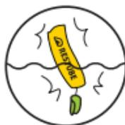
Durch Kontakt mit Wasser erfolgt automatische Auslösung des Restubes. Die Boje füllt sich mit CO<sub>2</sub>.
